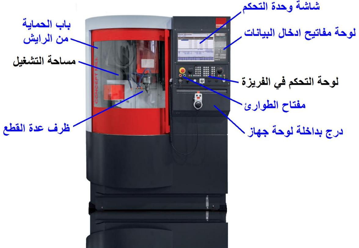
شكل رقم ١: أجزاء الفريزة CNC ماركة EMCO 260
